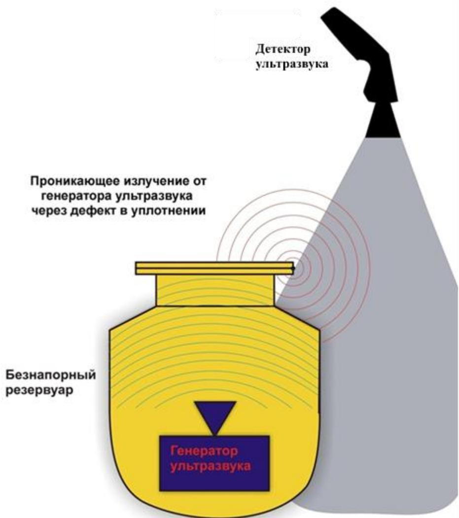
**Контроль герметичности безнапорных резервуаров с помощью генератора и детектора ультразвука**
